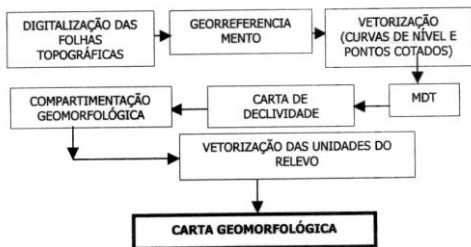
Figura 02 - Roteiro esquemático para geração da Carta Geomorfológica do Riacho do Tabuleiro.
