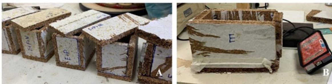
Figura 4. Painéis de madeira em caixas para teste de isolamento acústico (A); Análise de isolamento acústico em caixa de painel de Eucalyptus.
