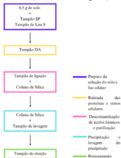
Figura 08: Fluxograma geral do protocolo do kit para extração e purificação de DNA de solo com colunas de sílica – RUO (Nova Biotecnologia ®)
