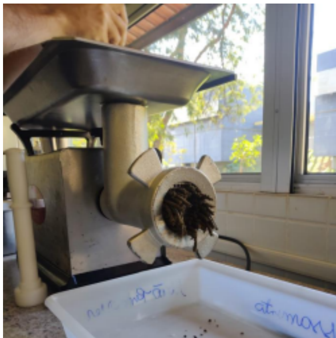
Figura 3- Lemnas em processo de peletização
