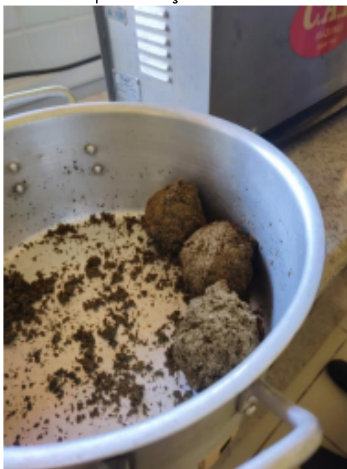
Figura 4- Adição de água e aglutinante na lemna seca para iniciar o processo de peletização
