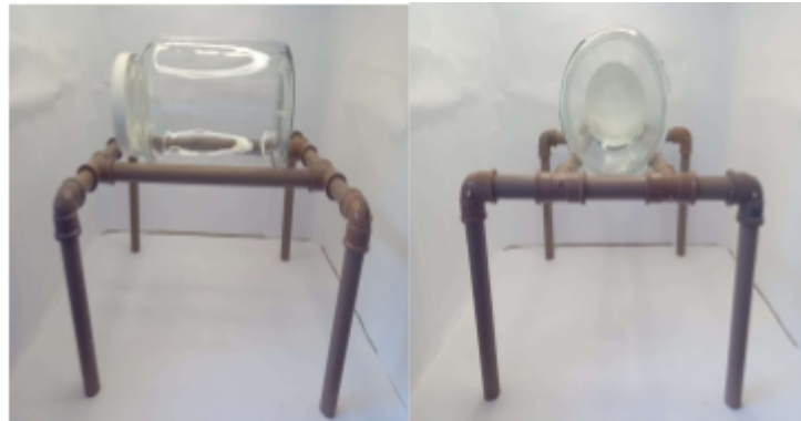
Figura 1 – Tambor rotativo de vidro e suporte de PVC.
