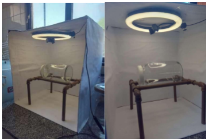
Figura 2 – Estúdio fotográfico de bancada Meios particulados Padronização da umidade
