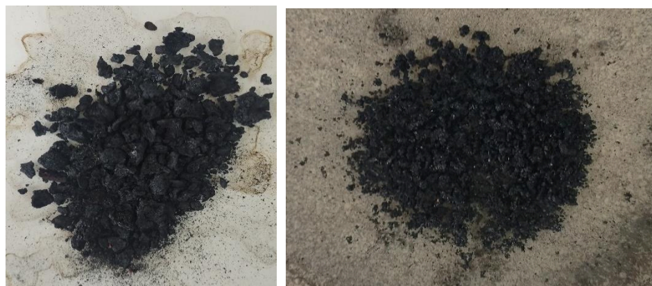
Figura 3 - Carvões impregnados com KOH e metóxido de sódio 30%.
