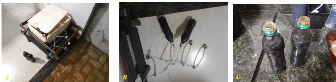
Figura 01. Sistema usado para avaliar a precipitação de sais de lítio com o uso de biogás de água marinha. (A) Sistema de geração de biogás a partir da biomassa. (B) Sistema de tubulação para 'purga' de biogás na amostra. (C) Recipientes para as amostras de água marinha.
