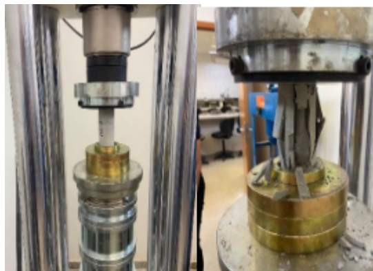
Figura 3. Rompimento à compressão
