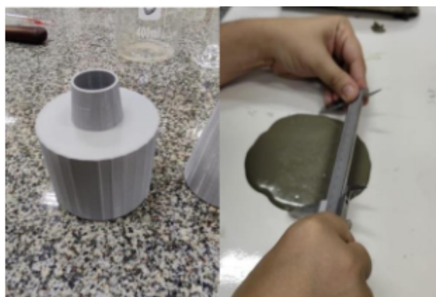
Figura2. Ensaio mini slump de Kantro.
