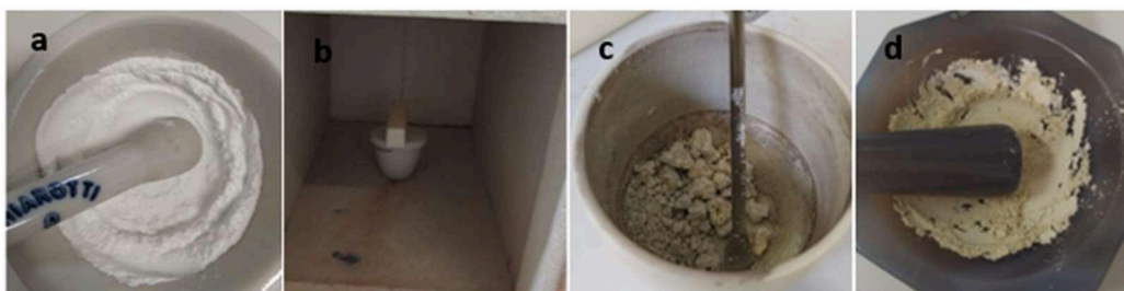
Figura 1: Esquema de síntese do nitreto de carbono grafítico.
