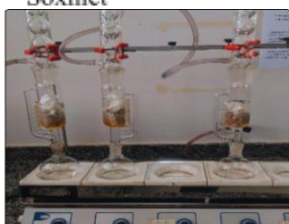
Figura 6 - Extração via Soxhlet
