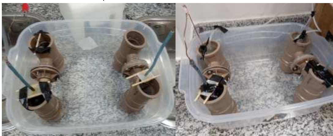
Figura 2 – CCMs do Experimento 1 a esquerda sendo montadas e CCMs do Experimento 2 em funcionamento.
