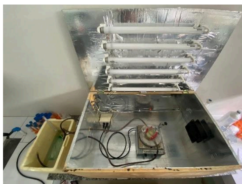
Figura 2: Caixa de fotocatálise desenvolvida no laboratório.
