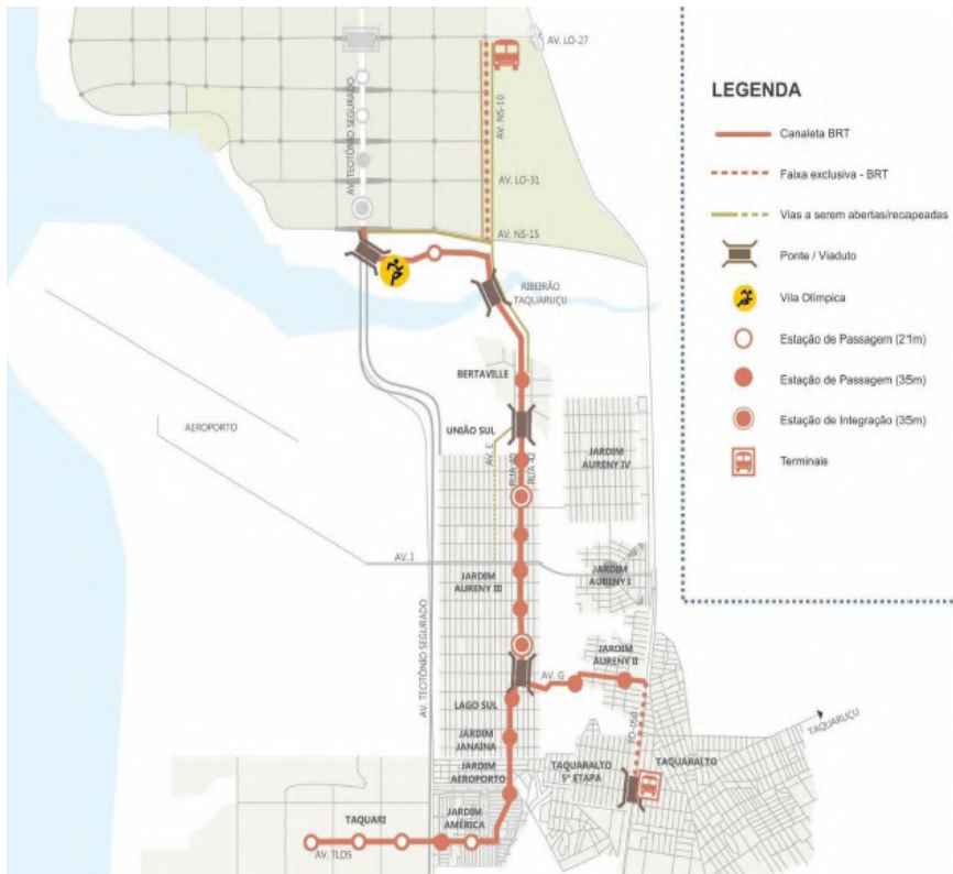
Figura 6: Planta de Situação do BRT Palmas Sul apresentada no Termo de Referência do Processo Licitatório RDC Eletrônico nº 01/2015. Em vermelho a canaleta do BRT com a localização das pontes, viadutos e estações.
