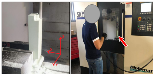
Figura 5 - SKYBULL 600M DIPLOMAT (Usinagem do corpo do carro).
