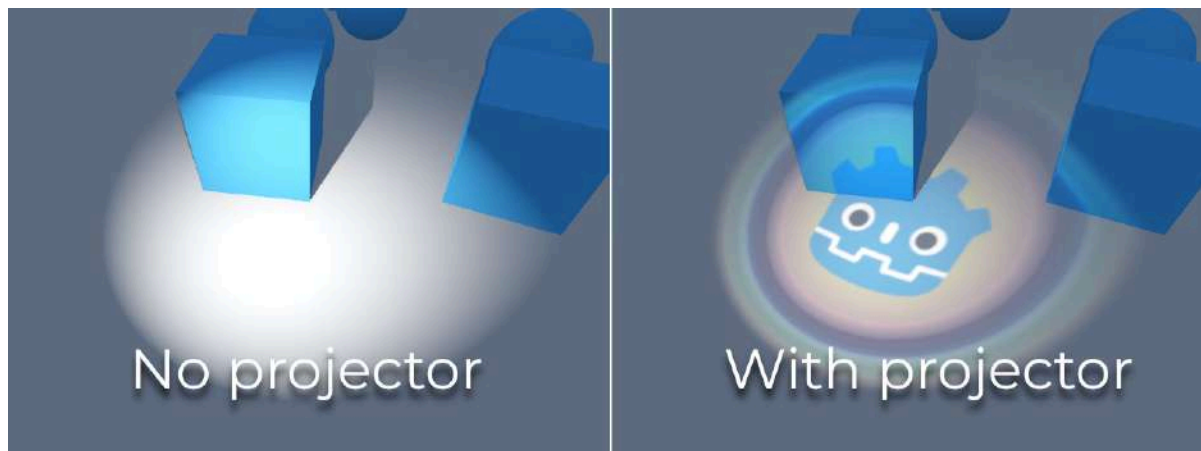
Figura 3.16. Luz spot (Spot Light): semelhante à luz omni, mas emite luz apenas dentro de um cone direcional. É usada para simular lanternas, faróis, refletores e holofotes. Esse tipo de luz sofre atenuação fora da direção apontada e pode utilizar projetores quando as sombras estão ativadas, aplicando uma textura que modula a cor e a intensidade da luz. Ao usar projetores, a iluminação tende a parecer mais escura, sendo necessário ajustar a energia para compensar. Disponível em: https://docs.godotengine.org/en/stable/tutorials/3d/lights_and_shadows.html
