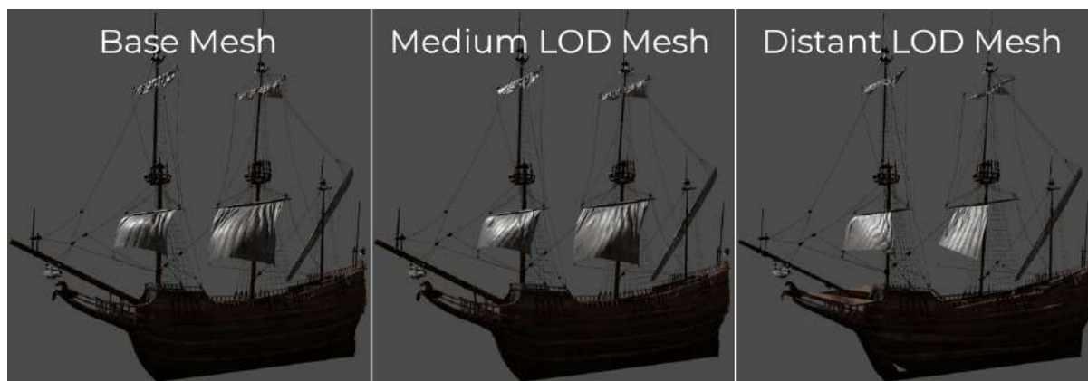
Figura 4.22. Exemplo de malhas de LOD geradas durante a importação. À medida que a câmera se afasta do objeto, versões com menor nível de detalhe são utilizadas para otimizar o desempenho. Da esquerda para a direita: da malha mais detalhada para a menos detalhada, em visualização sombreada. Disponível em: https://docs.godotengine.org/en/stable/tutorials/3d/mesh_lod.html
