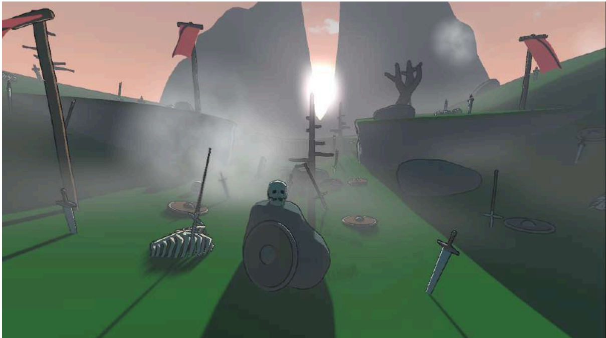
Figura 11.12. Exemplo de Toon Shader (cel shading) no Godot implementado em código. O shader modular usa múltiplos includes e parâmetros configuráveis (cor, textura base, especular, fresnel, transparência, reflexões etc.), criando um visual estilizado com sombras em blocos e realces típicos de animações. Disponível em: https://godotshaders.com/shader/complete-cel-shader-for-godot-4/
