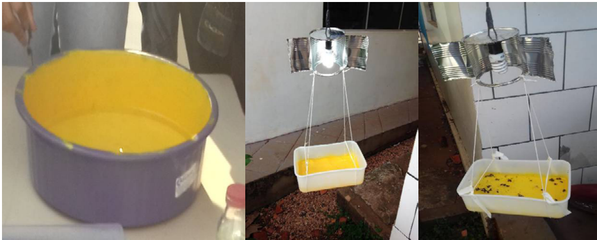
Figura 2A-B. (A) Bandeja D'água com fundo amarelo e (B) Armadilha luminosa, feita com lata e lâmpada fluorescente.
