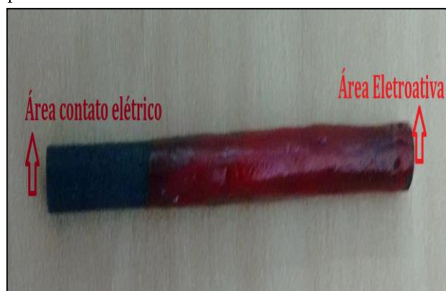
Figura 1: Eletrodo de trabalho confeccionado a partir de pilhas descartadas.
