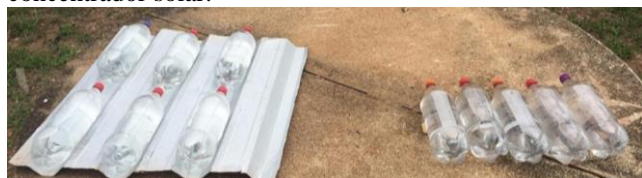
Figura 3: Amostras expostas ao sol com e sem o concentrador solar.
