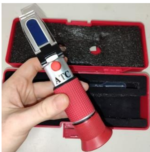
Figura 2: Refratômetro específico para análise de ARLA 32.
