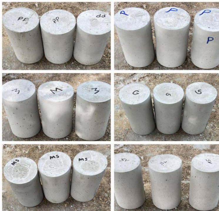
Figura 4 – Corpos de prova com as granulometrias PP, P, M e G, combinação de todas as granulometrias e sem adição do vidro (SV).
