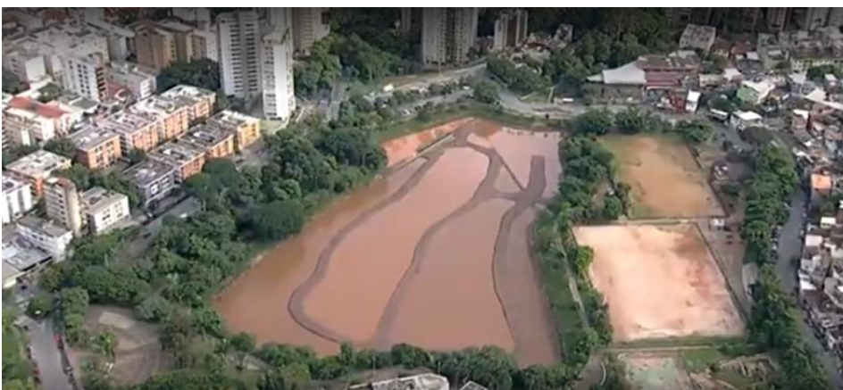
Figura 7 – Praça-Piscina com água acumulada na parte com cota inferior as demais.
