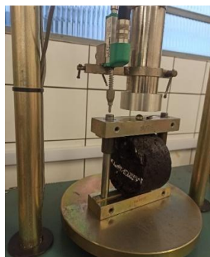
Figura 8 – Ensaio de resistência à tração por compressão diametral
