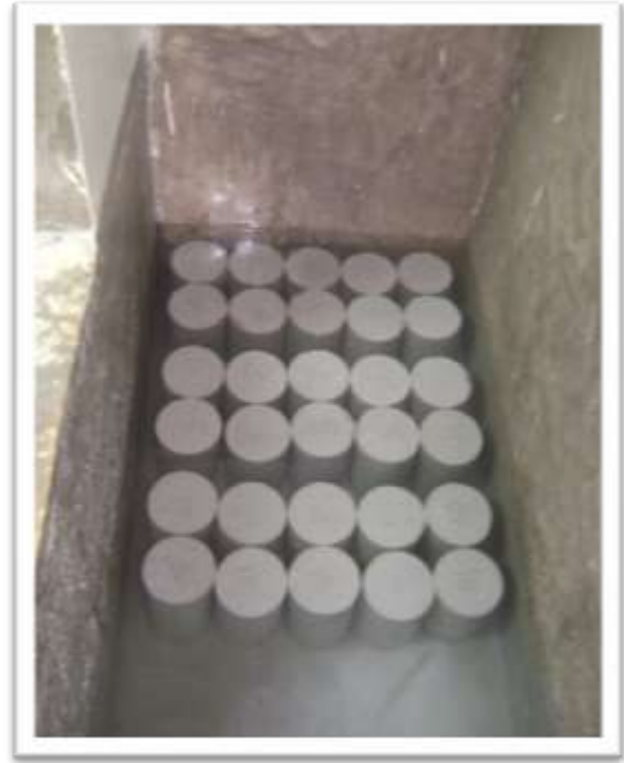
Figura 4.5.1: Corpos de prova em cura úmida.
