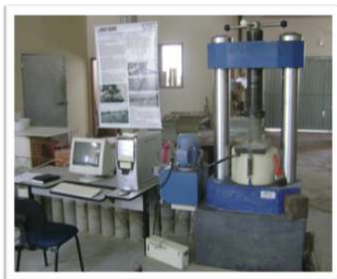
Figura 4.6.1: Prensa eletrônica utilizada nos ensaios, capacidade de 200KN.
