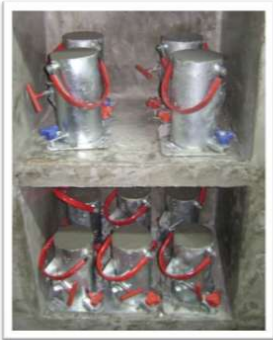
Figura 4.4.1: Corpos de prova moldados em fôrmas de 10x20cm.
