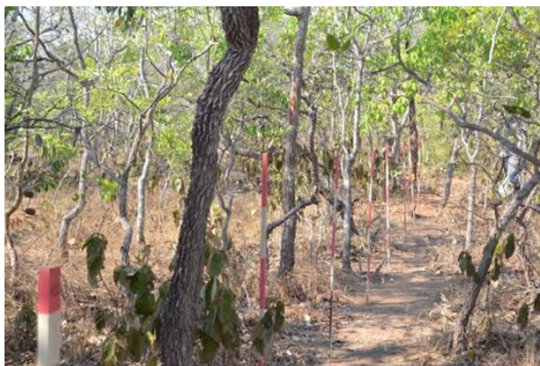
Figura 01 - Estacas graduadas dispostas a cada dois metros para obter leitura temporal do fogo
